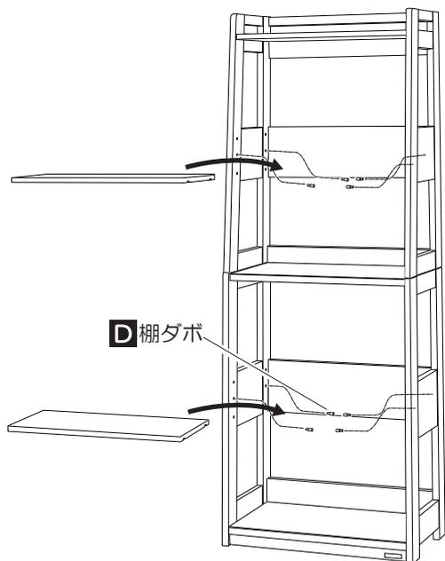
①左の図を参照して、シェルフ上台・下台の側板内面に、棚ダボを左右2個ずつ取り付け、可動棚を取り付けてください。
